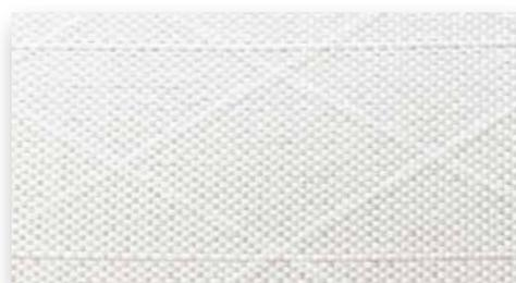
Un assemblage de composants plus ou moins chargés en Dyneema® permet de proposer une gamme complète en «One Side Ultra PE\*», pour les trois grammages légers (245 – 445) et «Two Side Ultra PE\*\*» pour les grammages lourds (495 – 645). Tous les laminés ZZ Ultra PE ont des inserts d'Ultra PE en chaîne à 0° et dans le biais à 70°. Le ZZ Ultra s'illustre par sa souplesse et sa légèreté qui facilite les manœuvres et diminue le vieillissement à l'usage.
